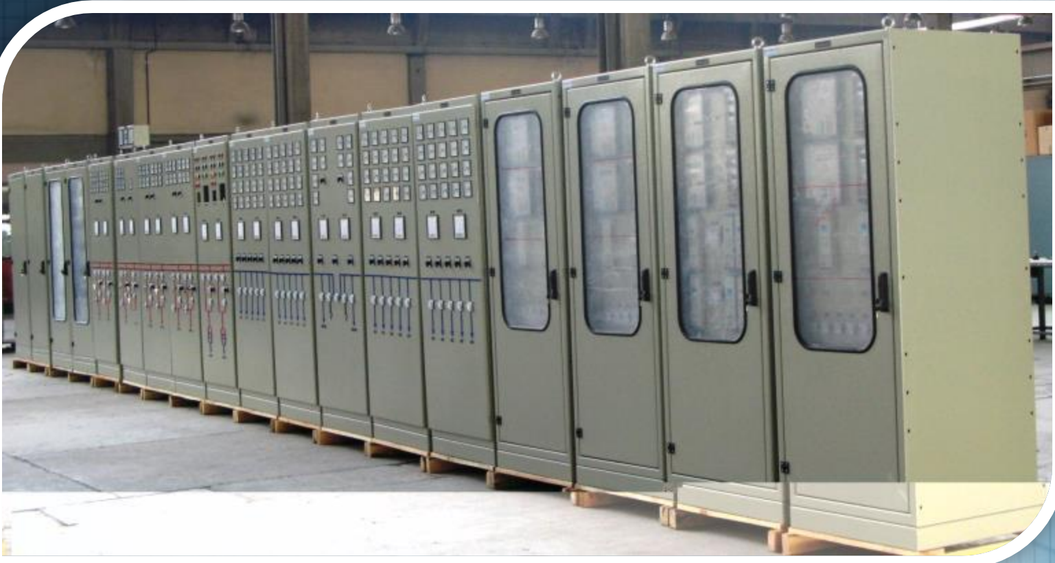
154kV - 36kV KONTROL VE RÖLE PANOLARI
